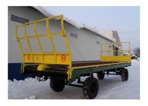
Тракторный самосвальный полуприцеп 1ПТС-2,5 предназначен для перевозки различных сельскохозяйственных грузов по всем видам дорог общей сети  $P\Phi$  и в полевых условиях и их самовыгрузки. Эксплуатация прицепа возможна с колесными тракторами классов 0,9-1,4 кH, имеющими тягово-сцепное устройство, пневматический привод тормозной системы, электро- и гидроприводы.
