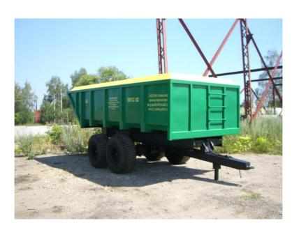
Тракторный самосвальный полуприцеп ППТС-12 предназначен для перевозки и выгрузки назад различных сельскохозяйственных грузов по всем видам дорог общей сети  $P\Phi$  и в полевых условиях и их самовыгрузки. Эксплуатация прицепа возможна с колесными тракторами классов 1,4-3,0 кH, имеющими тягово-сцепное устройство, пневматический привод тормозной системы, электро- и гидроприводы.
