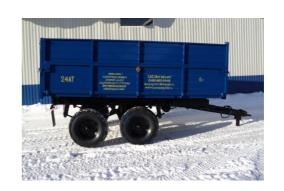
Тракторный самосвальный полуприцеп ППТС-10 предназначен для перевозки и выгрузки назад различных сельскохозяйственных грузов по всем видам дорог общей сети  $P\Phi$  и в полевых условиях и их самовыгрузки. Эксплуатация прицепа возможна с колесными тракторами классов 1,4-3,0 кH, имеющими тягово-сцепное устройство, пневматический привод тормозной системы, электро- и гидроприводы.
