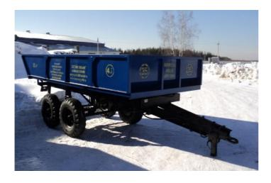
Тракторный самосвальный полуприцеп ППТС-5 предназначен для перевозки различных сельскохозяйственных грузов по всем видам дорог общей сети  $P\Phi$  и в полевых условиях и их самовыгрузки. Эксплуатация прицепа возможна с колесными тракторами классов 1,4-3,0 кH, имеющими тягово-сцепное устройство, пневматический привод тормозной системы, электро- и гидроприводы.
