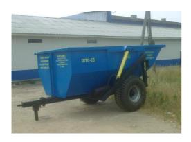
Тракторный самосвальный полуприцеп ППТС-4,5 предназначен для перевозки различных сельскохозяйственных грузов по всем видам дорог общей сети  $P\Phi$  и в полевых условиях и их самовыгрузки. Полуприцеп рассчитан на эксплуатацию при температуре окружающего воздуха от +40 до -40 $^{\circ}$  С. Эксплуатация полуприцепа возможна с колесными тракторами классов 1,4-3,0 кH, имеющими тягово-сцепное устройство, пневматический привод тормозной системы, электро- и гидроприводы.
