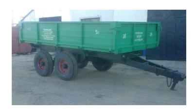
Тракторный самосвальный полуприцеп ППТС-6 предназначен для перевозки различных сельскохозяйственных грузов по всем видам дорог общей сети  $P\Phi$  и в полевых условиях и их самовыгрузки. Эксплуатация прицепа возможна с колесными тракторами классов 1,4-3,0 кH, имеющими тягово-сцепное устройство, пневматический привод тормозной системы, электро- и гидроприводы.
